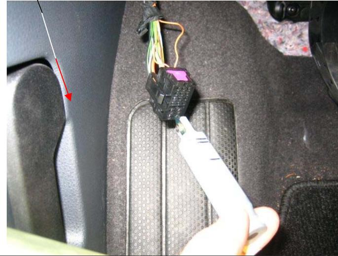
Blinker-Pins: pin14 und pin16
